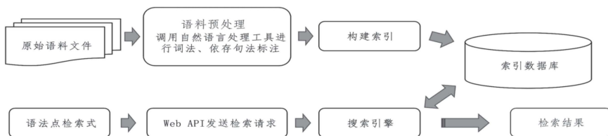
图1 语法点自动抽取流程
